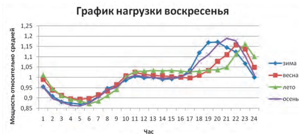
Рис. 11. График относительной нагрузки выходного дня
