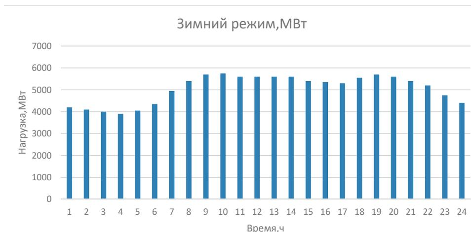
Рис. 50. График нагрузки энергосистемы Республики Беларусь в зимний рабочий день в 2020 г.
