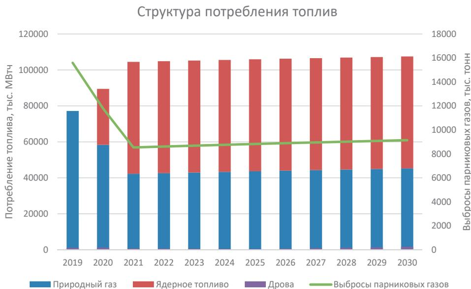
Рис. 69. Базовый (мин ВИЭ) сценарий. Динамика и структура потребления топлив и выбросов парниковых газов
