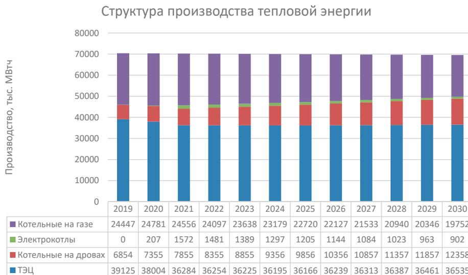
Рис. 72. Базовый (мин ВИЭ) сценарий. Структура производства тепловой энергии
