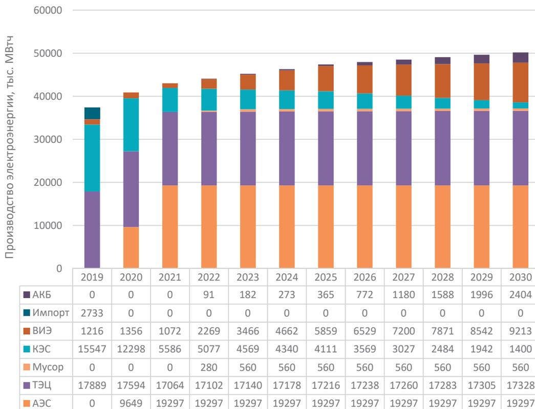
Рис. 114. Прогрессивный+ сценарий. Структура генерации электроэнергии
