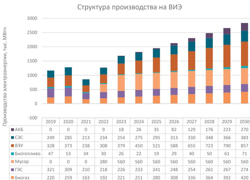
Рис. 67. Базовый (мин ВИЭ) сценарий. Структура производства на ВИЭ
