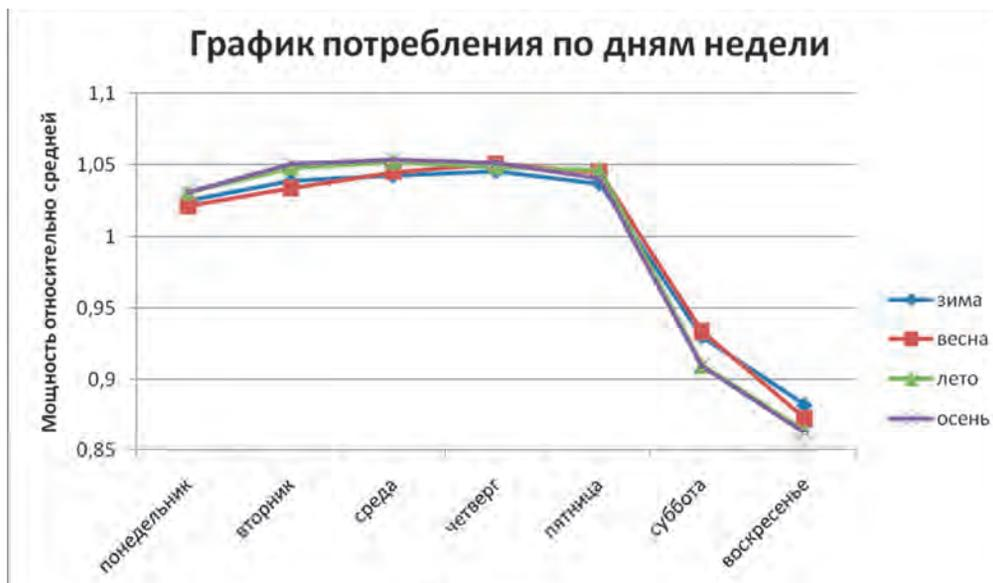
Рис. 12. График относительной нагрузки по дням недели
