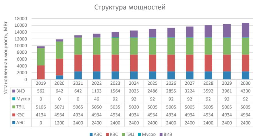
Рис. 117. Базовый сценарий. Результаты моделирования оптимальной структуры мощностей
