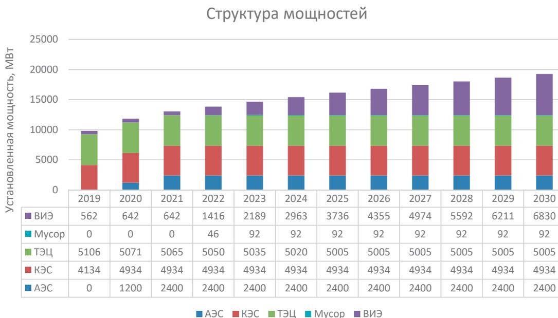
Рис. 108. Прогрессивный сценарий. Структура мощностей
